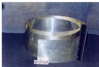
Композит из BSCCO/Ag толщиной 0,3мм
