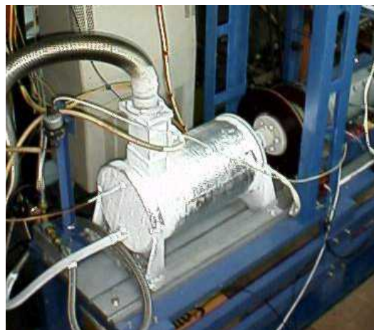
Рис. 3 Реактивный ВТСП двигатель 100кВт (50Гц).
