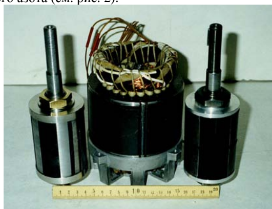
Рис. 2. Реактивный ВТСП двигатель 5кВт (50Гц).
