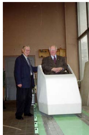
Рис. 3. Макет транспорта с магнитным ВТСП подвесом.
