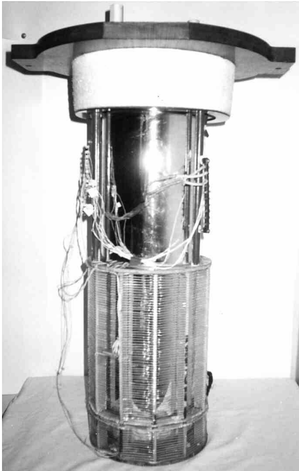
Рис. 1. Силовые обмотки и гелиевая полость криостата СПТ стержневого типа.
